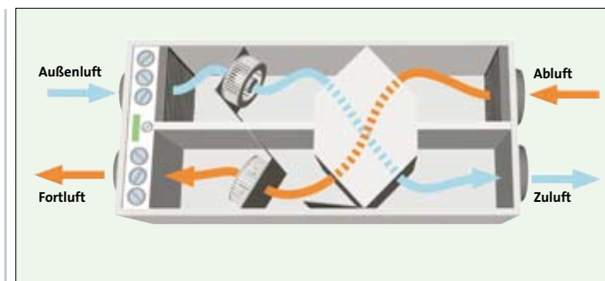
Bild 1: Funktionsschema Schullüftungsgerät SLG
